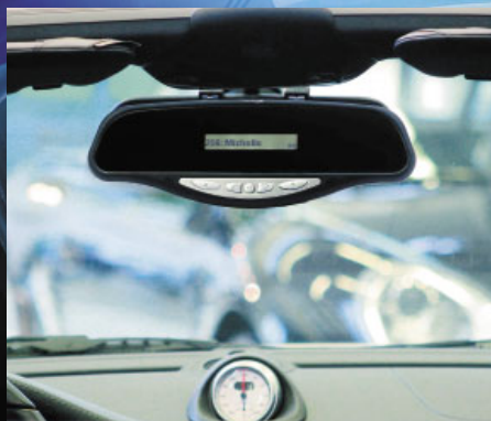
Die hochauflösende Matrixanzeige ist nur beim Blättern im Menü und beim Annehmen beziehungsweise Tätigen von Anrufen zu sehen.
