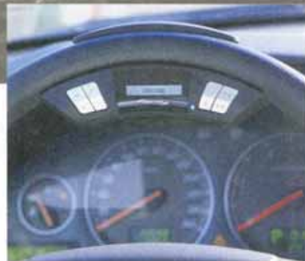
Geniale Lenkradlösung: Dank umschaltbarem Display kann das Wheel V2 nicht nur, wie hier im Bild, oben, sondern auch unten im Lenkrad montiert werden
